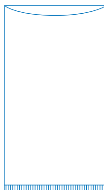
Bodennahtbeutel ohne Klappe, mit Ultraschall-Bodennaht
