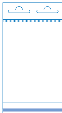
Headerbeutel mit 2 Eurolöchern, Klappe, Adhäsionsverschluss und Öffnung unten
